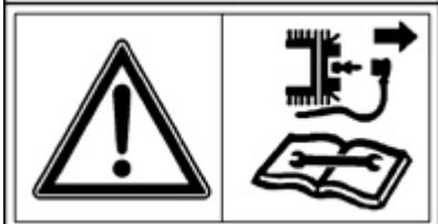
¡Desconectar el capuchón de la bujía y leer las instrucciones antes de efectuar cualquier operación de mantenimiento o reparación!
