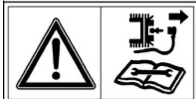
Scollegare il cappuccio della candela e leggere le istruzioni prima di effettuare qualsiasi operazione di manutenzione o riparazione!
